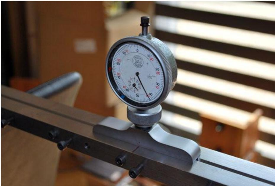
Placez le comparateur dans son support. Placez l'ensemble sur le gabarit centré sur le repère (*trait au feutre*) et déplacez le comparateur dans son support afin de le régler sur la mesure calculée précédemment, c'est à dire **3.75 mm**, (*dans notre exemple.*)
