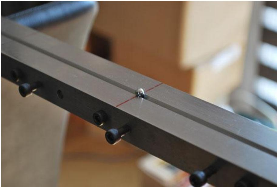
4) A l'aide d'un pied à coulisse digital, on va relever la dimension du bas du gabarit au sommet de la bille. **Côte "H" égale à 23.58mm.**
